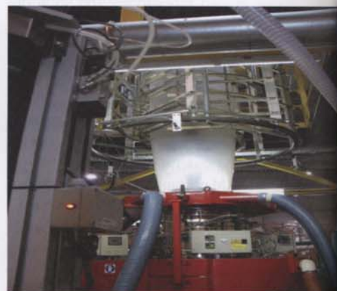
EcoCortec-ova visoko tehnološki osposobljena linija za ekstruziju spreman za ekstruziju
